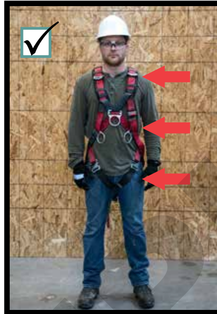
Adjust the PFAS for proper fit. Ajustar el PFAS para tener un ajuste adecuado.
