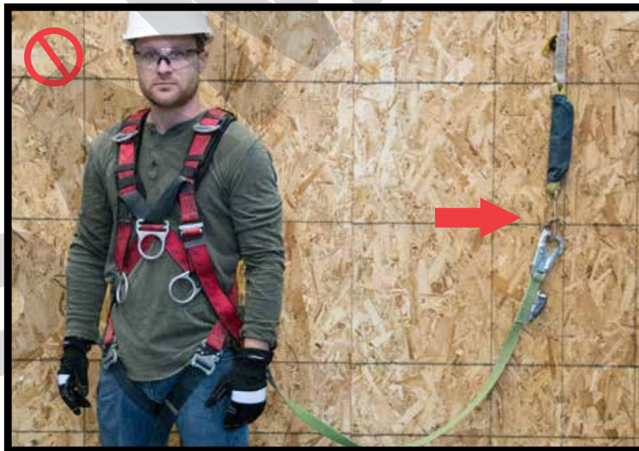
Do not connect two snap hooks together. No conectar juntos dos ganchos automáticos.
